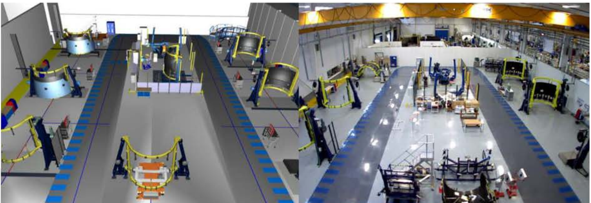
图2：在虚拟现实（左）和现实中（右）的A330装配线
